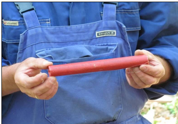
Fot. 18 Laska dynamitu – materiał wybuchowy. (Arch. PGNiG SA)
