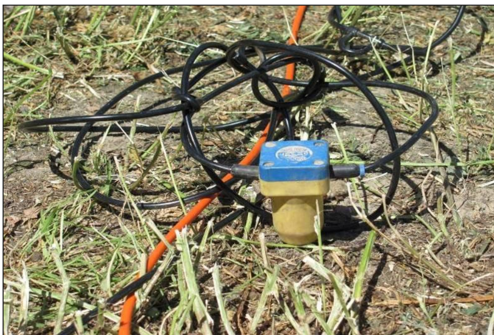
Fot. 1 Geofon podłączony do kabla przesyłowego. (Arch. PGNiG SA)
