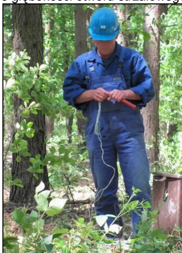
Fot. 22 Zbrojenie ładunku wybuchowego. (Arch. PGNiG SA)
