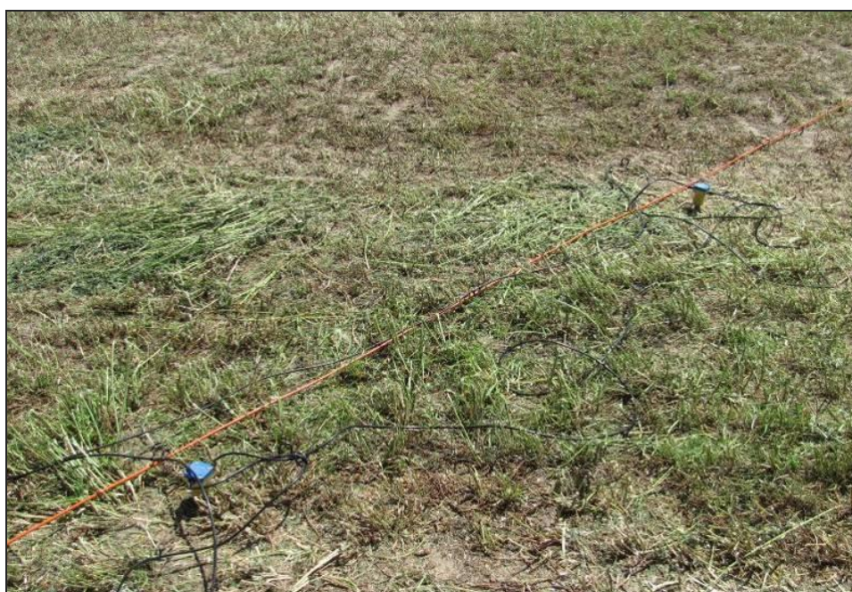
Fot. 2 Fragment linii pomiarowej z podłączonymi geofonami. (Arch. PGNiG SA)
