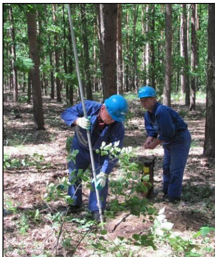
Fot. 21 Sprawdzanie głębokości otworu strzałowego. (Arch. PGNiG SA)
