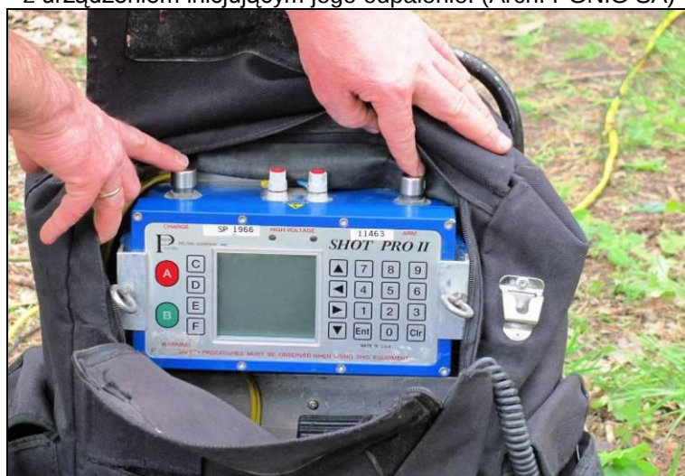
Fot. 28 Urządzenie inicjujące odpalenie ładunku wybuchowego w otworze. (Arch. PGNiG SA)
