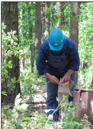
Fot. 23 Uzbrojony ładunek wybuchowy jest wkładany do lnianego worka, w celu ochrony łatwiejszego umieszczenia go w otworze strzałowym. (Arch. PGNiG SA)
