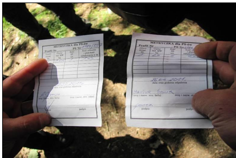
Fot. 29 Metryczka dla punktu strzałowego, zawiera informacje o ciężarze ładunku wybuchowego umieszczonego w jednym otworze strzałowym, ilości otworów w punkcie strzałowym oraz głębokości otworów strzałowych. (Arch. PGNiG SA)
