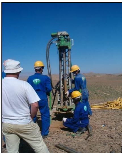
Fot. 10 Ręczne urządzenie do wiercenia płytkich otworów strzałowych. (Arch. PGNiG SA)
